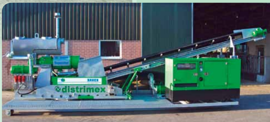
séparateur de phase
